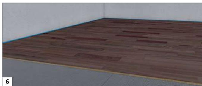
6 Il est également possible d'appliquer sur ce support du stratifié ou un parquet flottant prêt à poser. Pour le carrelage : Taille des carreaux minimum 10 x 10 cm, épaisseur des carreaux minimum 7 mm.
